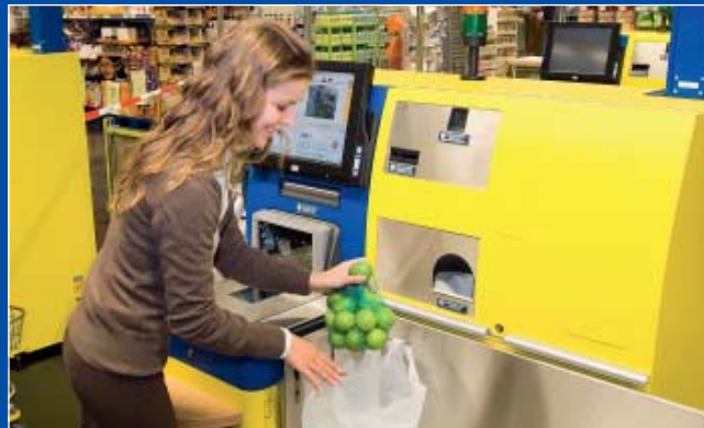
Artikel transportgerecht einpacken. Die eingebaute Waage prüft, ob der richtige Artikel gescannt wurde.
